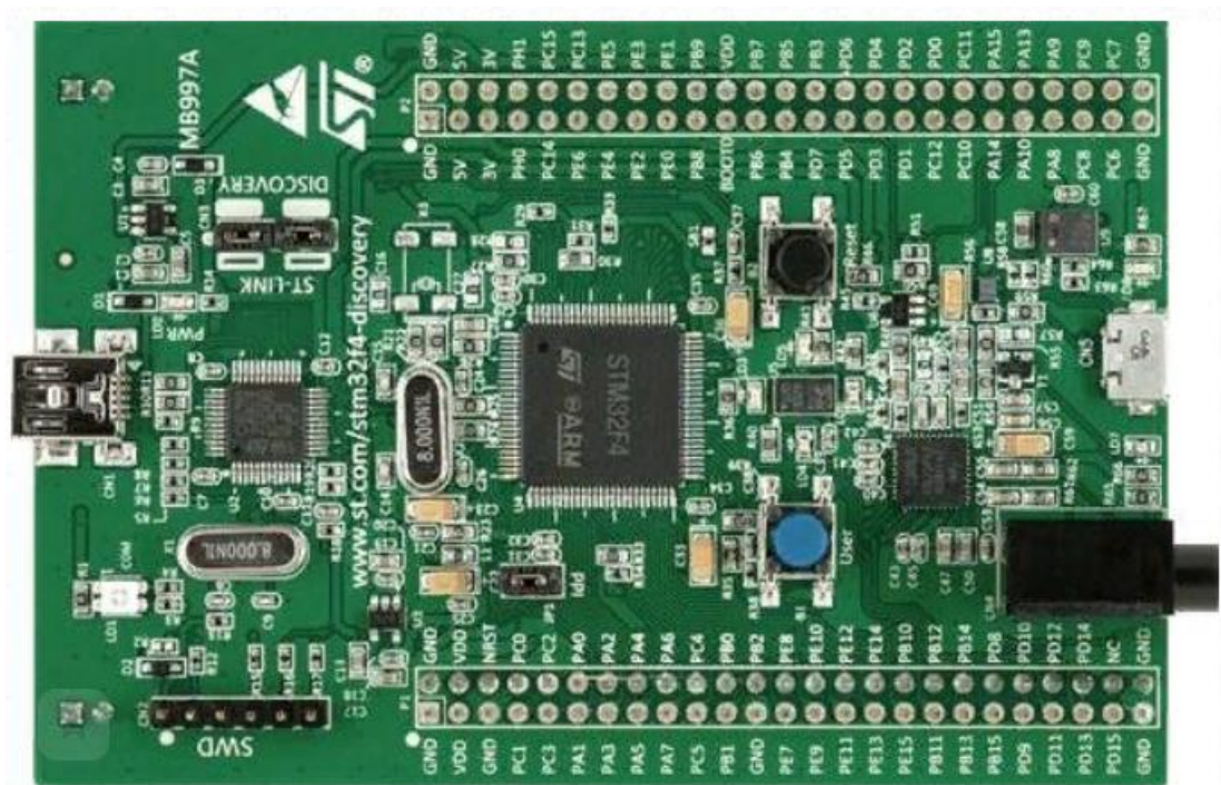
Рис.1. Общий вид платы STM32F407VG
